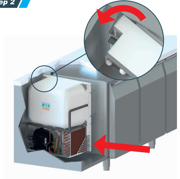
Fit MTT monoblock in the rail Inserire il monoblocco MTT nella guida
